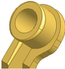
Nei casi in cui convergano più di tre spigoli, è possibile applicare dei raccordi speciali. Se necessario, scegliere un raggio diverso per ogni spigolo convergente.
