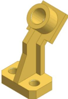
A questo punto, aggiungere degli smussi con distanza diversa per completare la forma di base del supporto dell'alloggiamento dell'albero.
