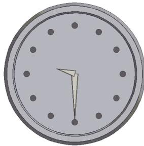
Vincolo animato per simulare un orologio. La lancetta dei minuti e quella delle ore sono vincolate al quadrante. L'animazione dei vincoli ruota la lancetta dei minuti. Lo strumento Parametri definisce la posizione della lancetta delle ore in funzione della posizione della lancetta dei minuti.
